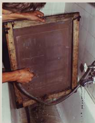
3. Płukanie sita po naświetleniu emulsji
